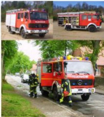
Typ: Tanklöschfahrzeug 16/25 (Pumpenleistung 1600 l/min, mit 2400 Liter Tankkapazität)
